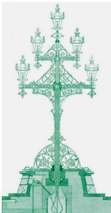
Разрез уличного фонаря газового освещения, XIX в.
